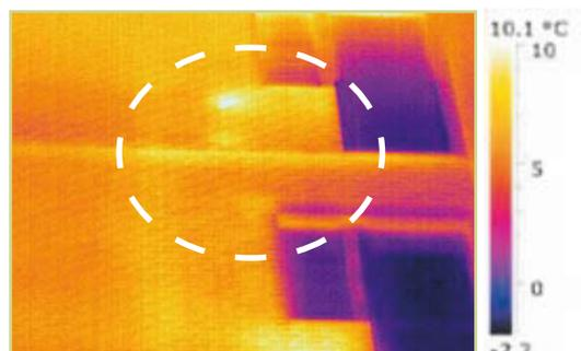
Assenza di dispersione di calore con sistema ThermoRadiant
